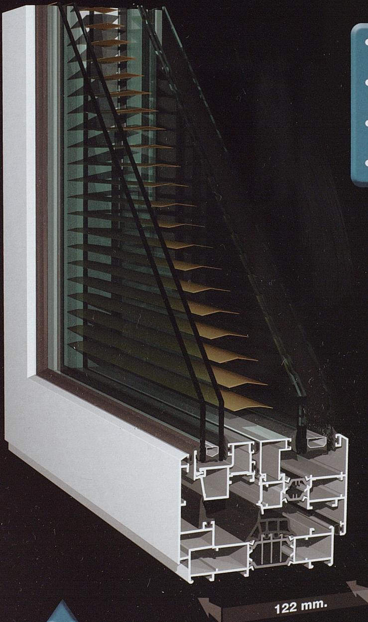
**Cor Urban** es un nuevo concepto de ventana especialmente diseñada para la vida urbana. Su doble ventanal de **122 mm.** de profundidad con posibilidad de cuádruple acristalamiento y una cámara de **45 mm.** que permite la instalación de una veneciana (manual o motorizada) o un store, le confieren los niveles más exigentes de aislamiento térmico y acústico.
